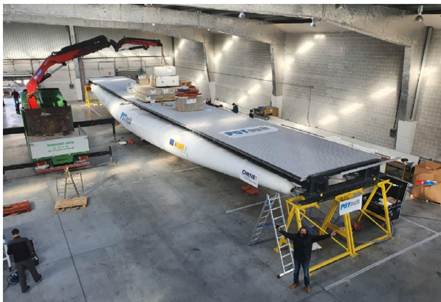
Prototipo de puente de estructura hinchable. Fuente: Buildair – Centro Internacional de Métodos Numéricos en Ingeniería (CIMNE) – Universidad Politècnica de Catalunya.
